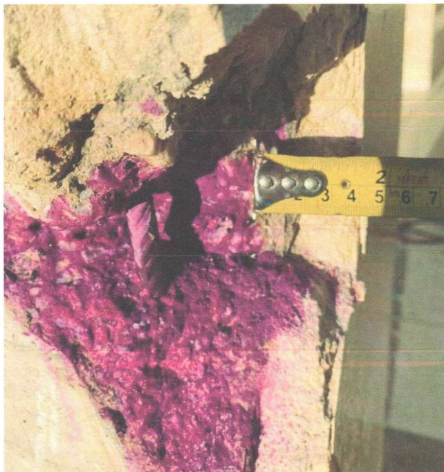
Ensaio de carbonatação em pilar do pavimento inferior – Constatação de carbonatação de 1,5 a 2,0 cm de profundidade
