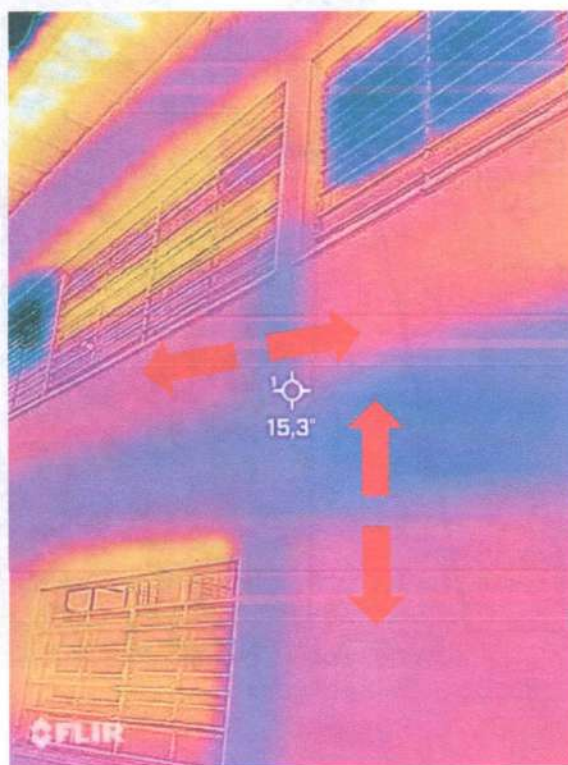
Exemplo de movimentações térmicas e dimensionais
