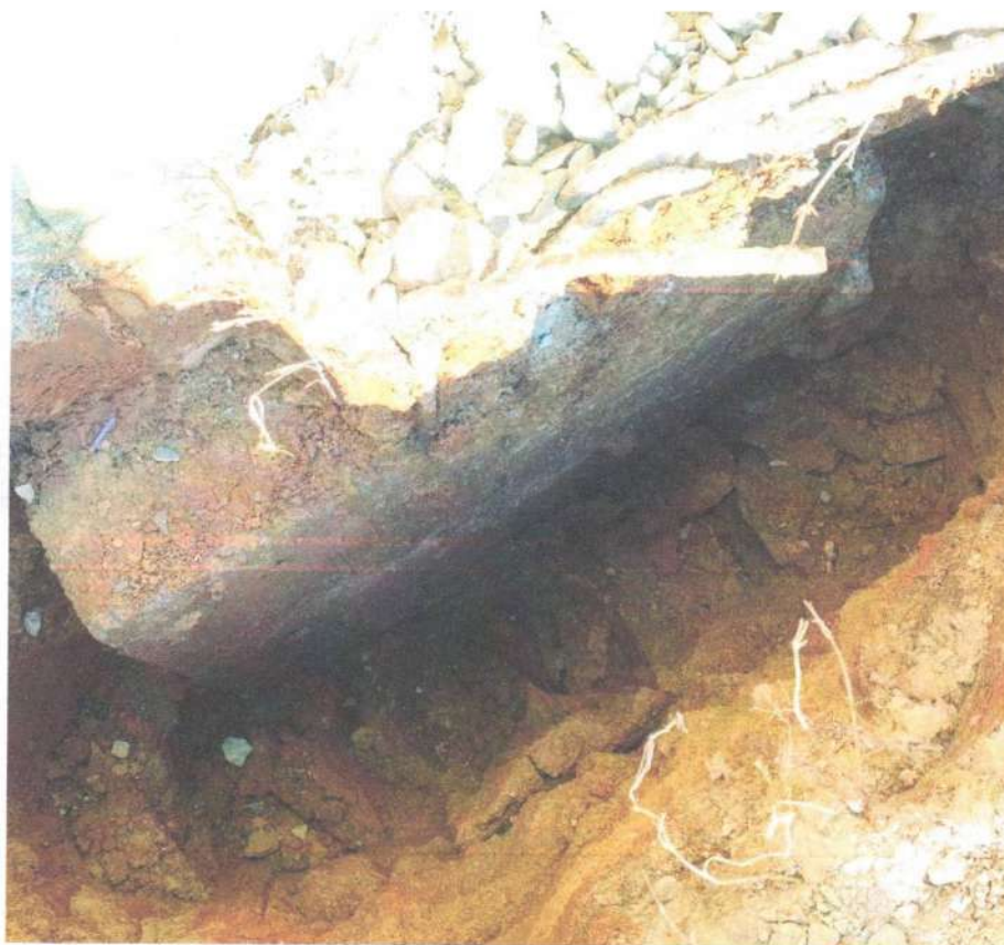
Realização do ensaio de prospecção de fundação
