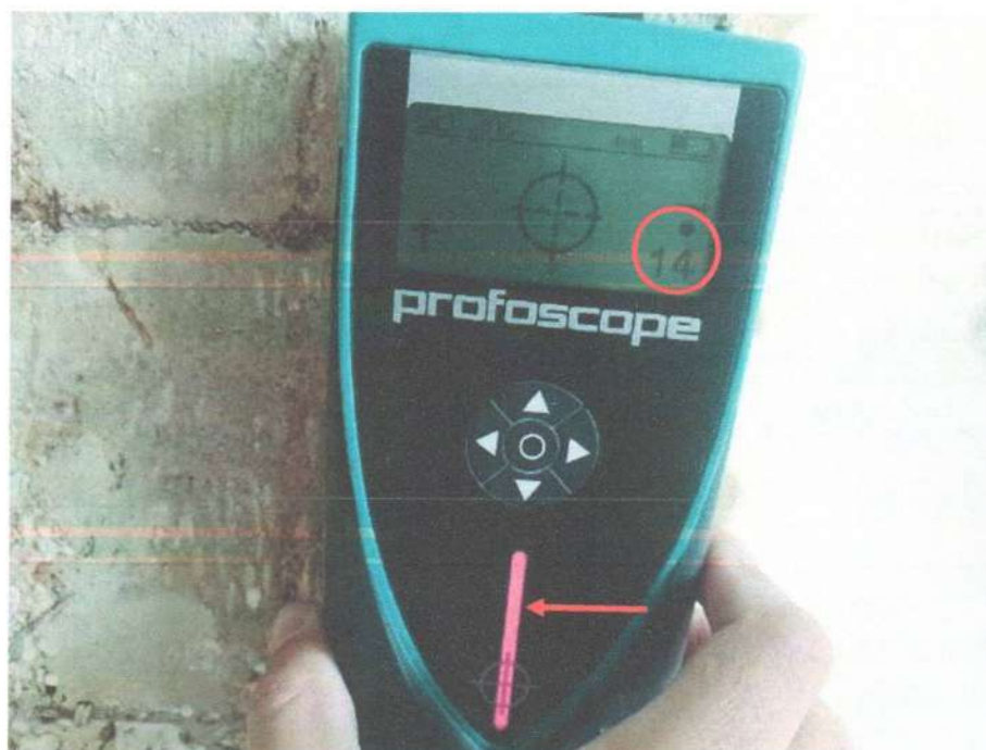
Realização do ensaio para verificação de barras de aço
